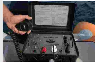
Une station surface munie d'un hydrophone
